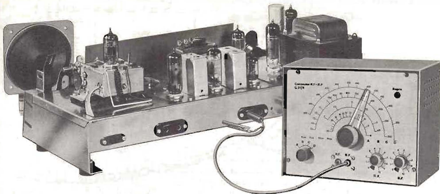
Comprobación del amplificador de B.F. en conjunto. Debe estar pulsada la tecla de "fono".
