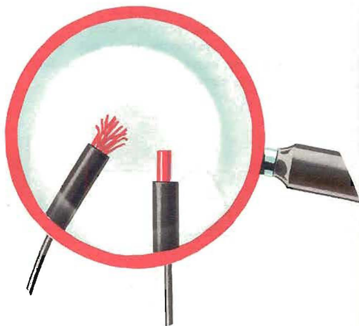
Cuando un bobinado debe poseer un Q elevado se emplea un cablecito especial de varios cabos, pues de esta forma se consigue reducir la resistencia para las señales de alta frecuencia.
